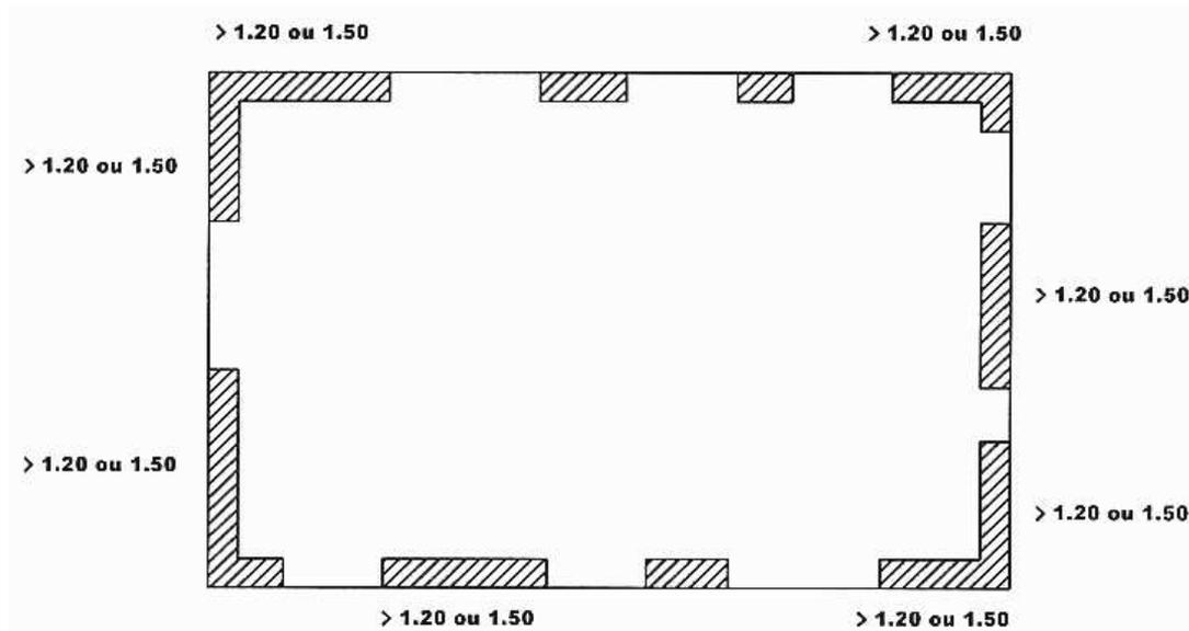
• La distance horizontale ou verticale entre 2 ouvertures ne sera en aucun cas inférieure à 0,50 m.
