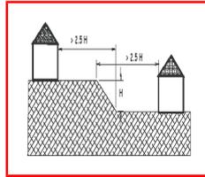
Les bâtiments doivent être implantés en dehors d'un terrain dont la pente moyenne (terrain naturel<sup>(\*)</sup>) est supérieure à :
