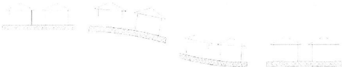
En fin d'affaissement, le bâti se trouve sur l'une de ces quatre configurations. A moins de prévoir la position finale exacte du bâti par rapport à la cuvette définitive, l'analyse du bâti doit tenir compte successivement des quatre configurations.
