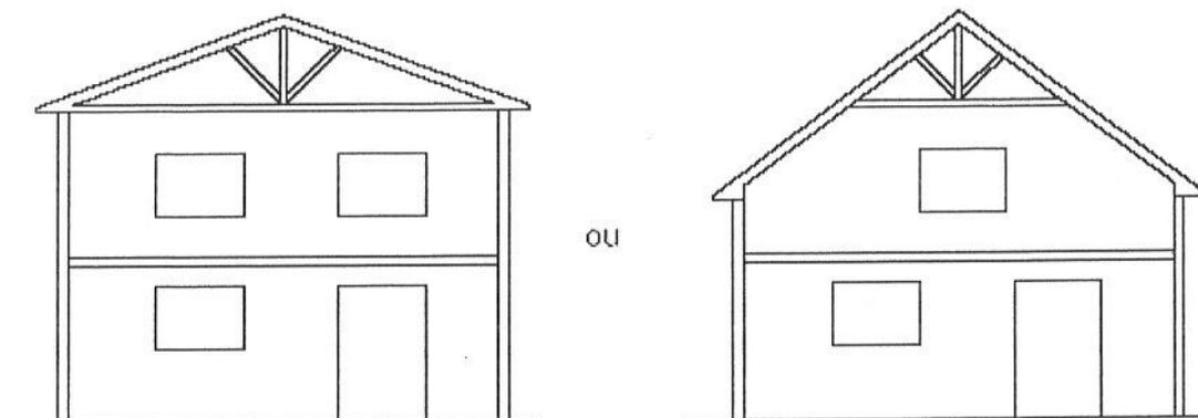
**Type 3 bis - Bâtiment à rez-de-chaussée et un étage, à ossature en bois ou en acier, de dimensions réduites.**
