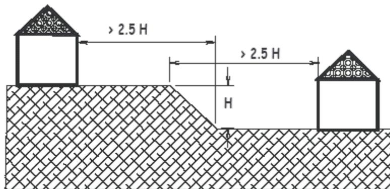
• Les bâtiments doivent être implantés en dehors d'un terrain dont la pente moyenne (**terrain naturel(\*)**) est supérieure à 25 % .
